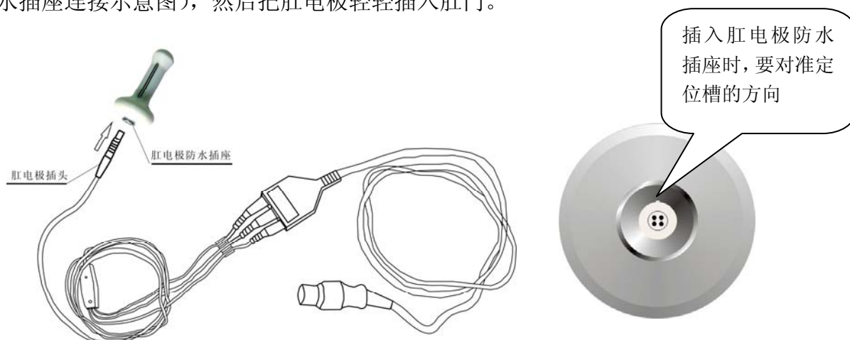
图 2 肛电极防水插座连接图和肛电极防水插座
